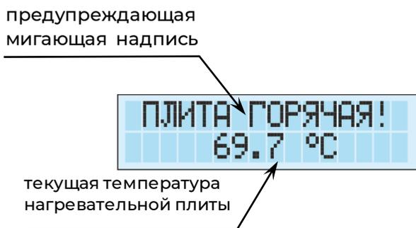
Рис. 9.2 Индикация предупреждения о высокой температуре плиты
